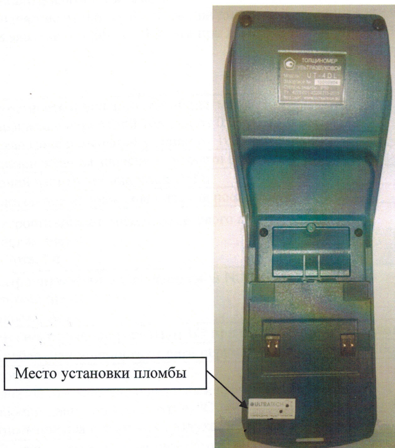
Рисунок 2 - Место пломбирования толщиномеров и место наклейки ярлыка
